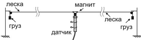
Грузы должны быть одинаковыми. При обрыве лески одного фланга вес груза противоположного фланга должен оторвать магнит.
